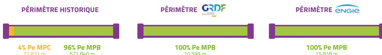
MPC : Moyenne Pression type C (entre 4 et 19,2 bar) - MPB : Moyenne Pression type B (entre 0,4 et 4 bar)
